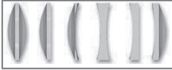
Resim 1.2. İnce kenarlı (konveks) ve kalın kenarlı (konkav) mercekler
