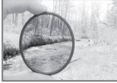
Resim 1.13. Kutuplama filtre etkisi ile oluşan görüntü
