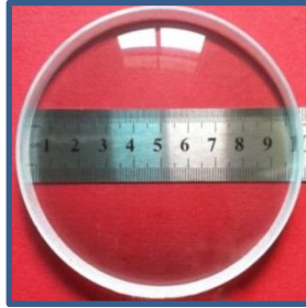
Resim 1.15. Gözlük camı/merçeği için çap
