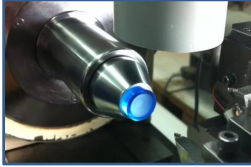
Resim 2.25. Torna kesme yöntemi ile kontak lens üretimi
